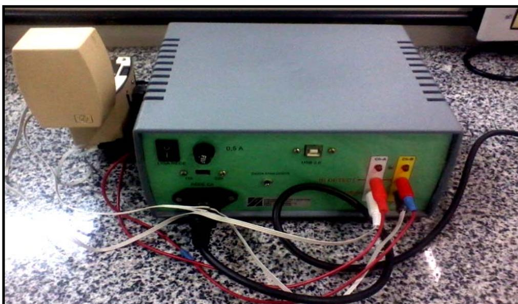
**Figura 10** – Vista posterior do fotômetro LED-NIR microcontrolado.
