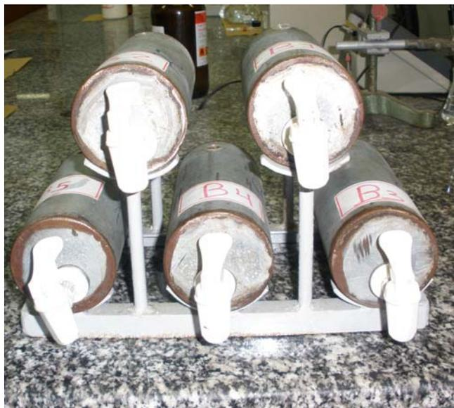
**Figura 4.4.** Tanques de aço carbono para armazenamento das amostras de biodiesel aditivadas e não aditivadas com antioxidantes.
