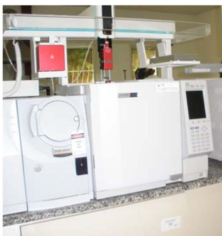
**Figura 4.2.** Cromatógrafo gasoso acoplado ao espectrômetro de massas GCMS-QP2010.
