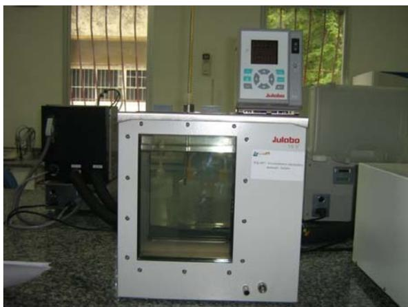
**Figura 4.3.** Viscosímetro Cinemático Manual marca Julabo, modelo ME 18V.
