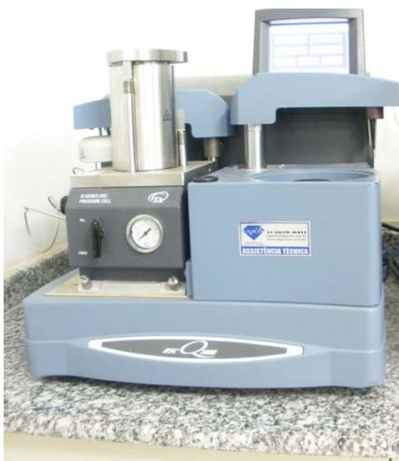
**Figura 4.5.** Calorímetro exploratório diferencial acoplado a uma célula de pressão.
