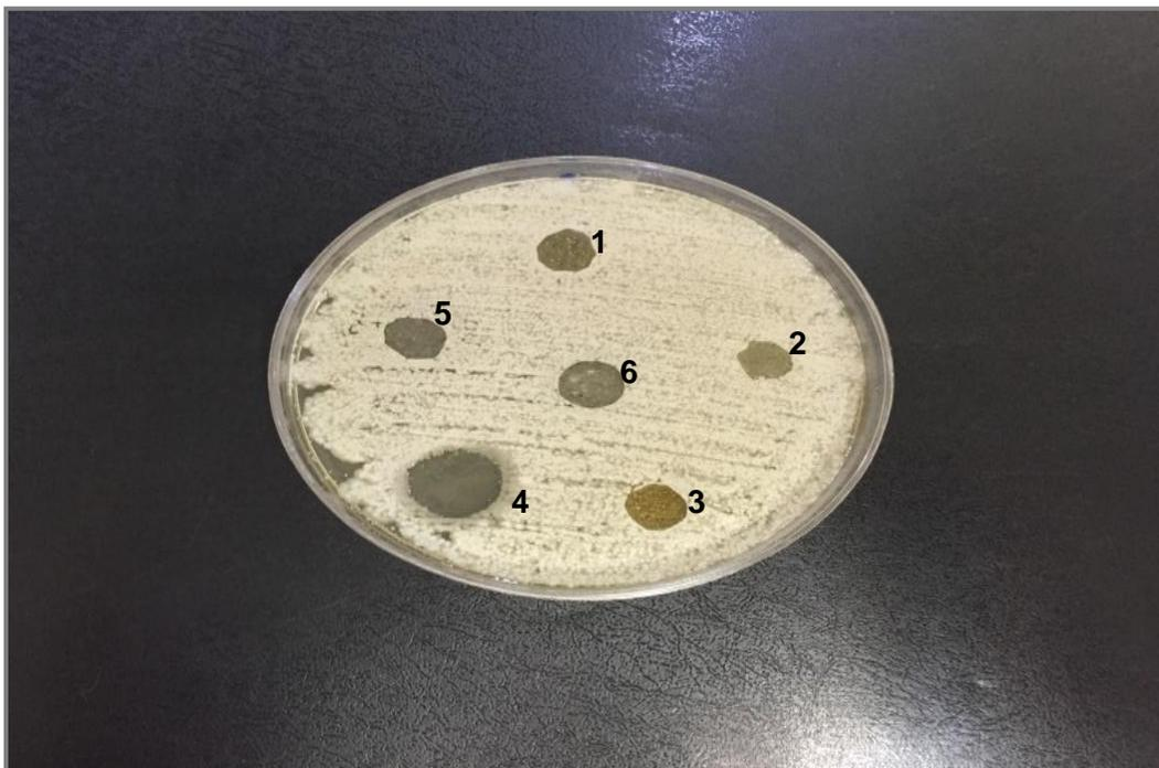
**Figura 36.** Resultado da avaliação da atividade biológica dos filmes poliméricos: GX/AC (20 %) (1), GX/PVA/AC (20%) (2), PVA/AC (20%) (3), GX (4), GX/PVA (5), e PVA (6) contra *S. aureus* ATCC-6538 pelo método de difusão em meio sólido-disco.
