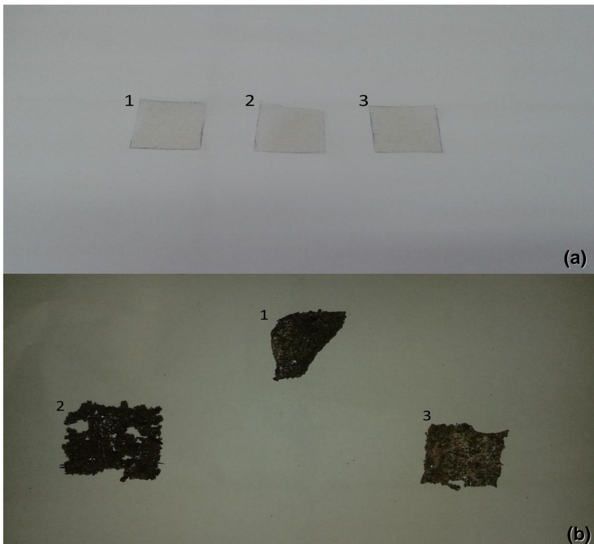
**Figura 34.** Filmes não reticulados constituído por GX (1), GX/PVA (2) e PVA (3) antes de serem submetidos ao ensaio de degradação em solo **(a)**. Filmes não reticulados constituídos por GX (1), GX/PVA (2) e PVA (3) após 14 dias de exposição do solo **(b)**.
