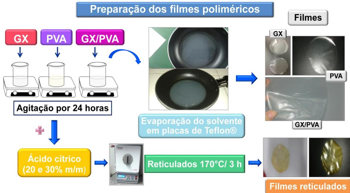
**Figura 23.** Esquema da preparação dos filmes poliméricos.
