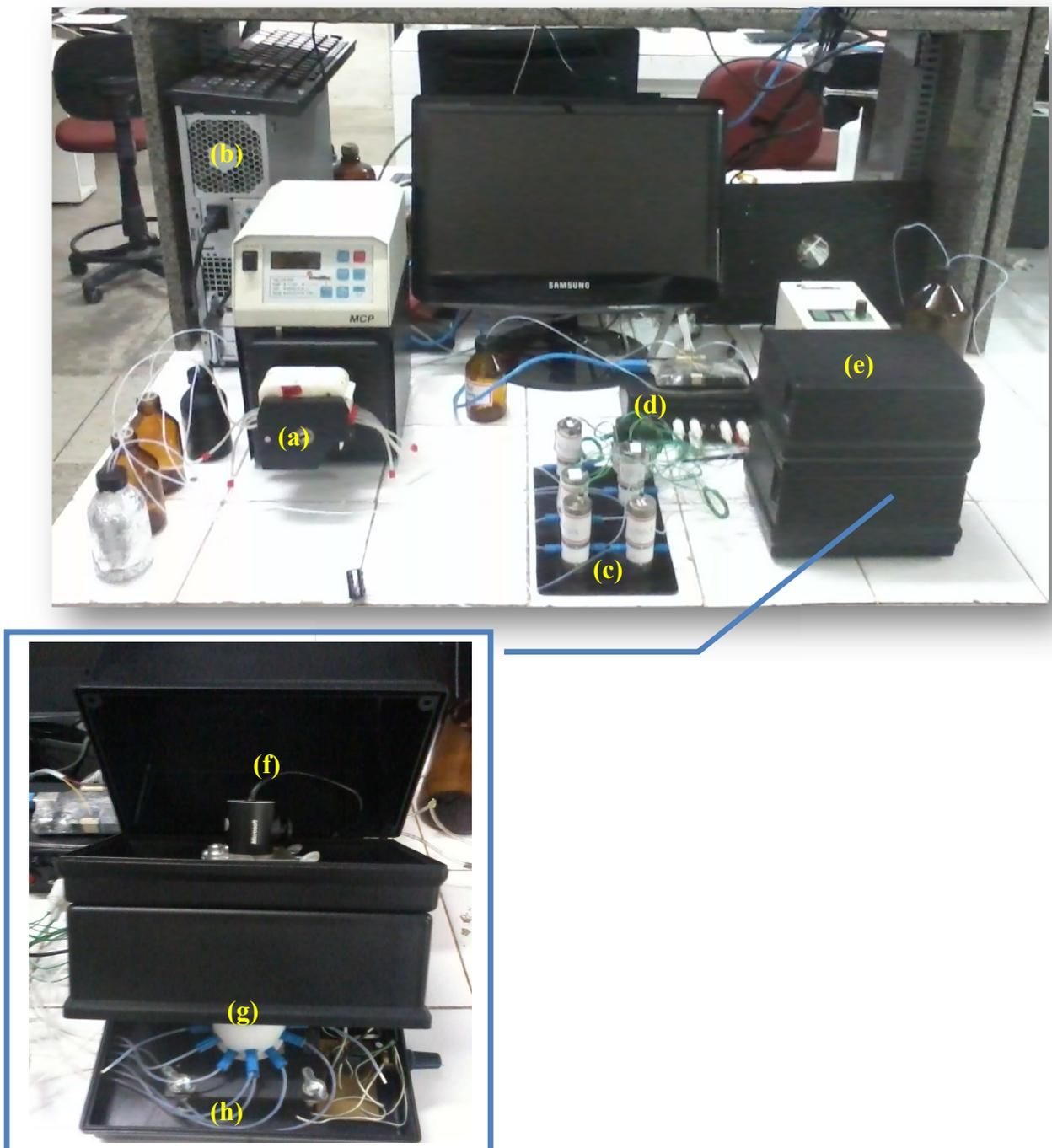
**Figura 2.1** – Fotografia da disposição física dos componentes do sistema de titulação QL-BID (a) bomba peristáltica, (b) microcomputador, (c) válvulas solenoides, (d) acionador de válvulas com interface arduino, (e) caixa para isolamento da luz externa, (f) *webcam*, (g) câmara de mistura e (h) agitador magnético.
