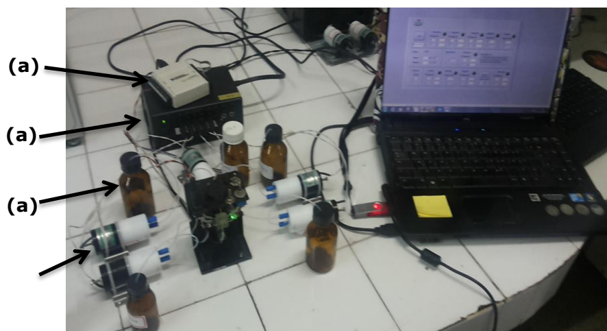
Figura 2.2: Representação do micronalisador fluxo batelada para a análise de sulfitos em bebidas: (a) interface USB, (b) acionador de válvulas, (c) frascos das soluções e (d) microbombas solenoides.
