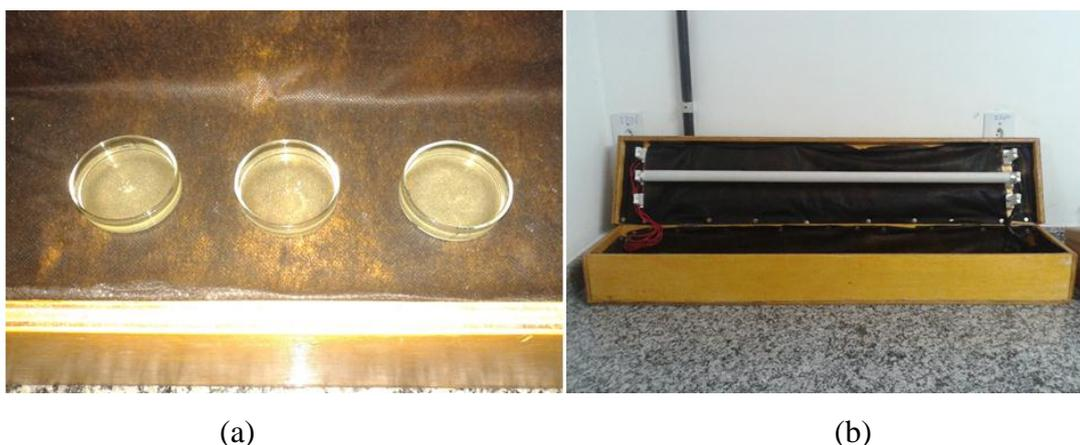
Figura 4.3.(a) Imagem das placas contendo o corante e catalisador, dentro do fotoreator; (b) Imagem do interior do fotoreator.
