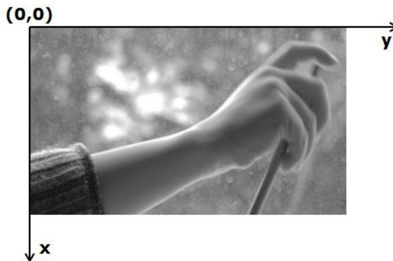
**Figura 2.13.** Imagem monocromática. Os níveis de cinza correspondem à intensidade luminosa da imagem  $f$  em cada coordenada espacial  $(x,y)$  que compõem a imagem.
