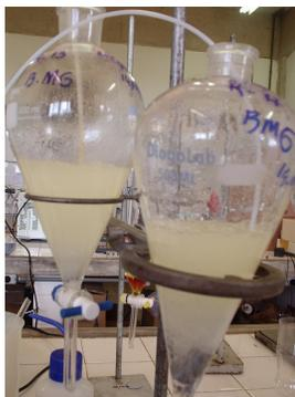
Figura 2.6. Demonstração da lavagem e borbulhamento de ar da reação de transesterificação.
