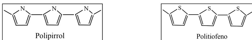
**Figura 1.6.** Ilustração das estruturas dos polímeros condutores *polipirrol* e *politiofeno*, cujas unidades correspondem a anéis heterocíclicos de *pirrol* e *tiofeno*.
