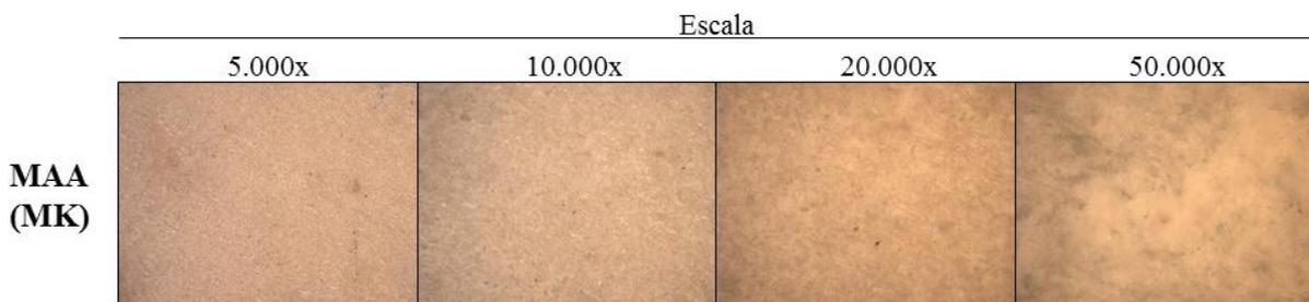
**Figura 34.** Micrografias do MAA a base de MK e Silicato de Sódio em diferentes ampliações.
