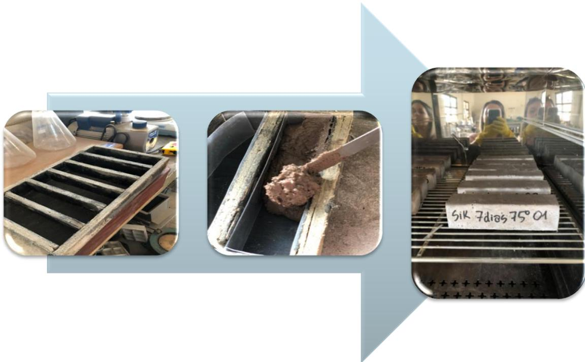
**Figura 29.** (a), (b) e (c). Forma de madeira naval, colocação do traço em forma e armazenamento das barras em temperatura de estudo. Fonte: Autor (2018).
