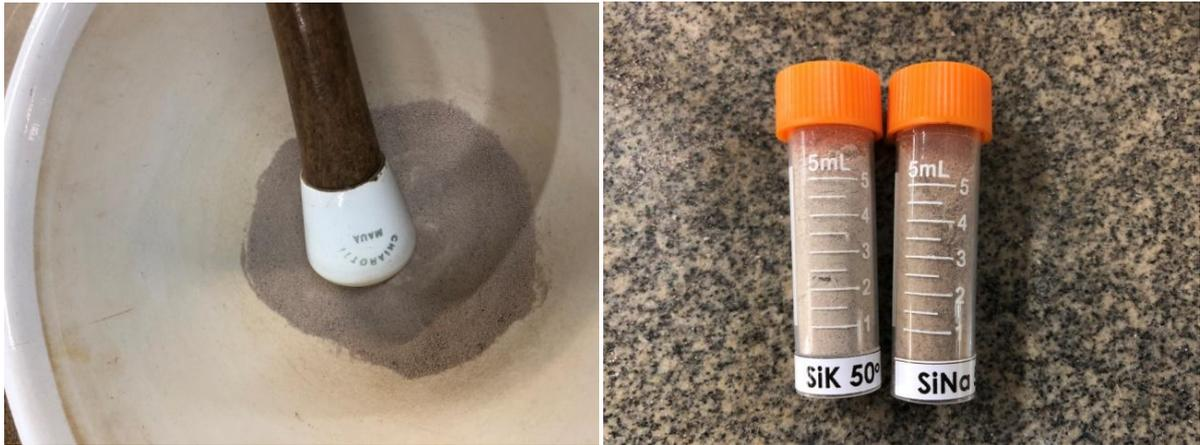
**Figura 31.** (a) Maceração das amostras das barras prismáticas (b) separação do material (Fonte: Autor, 2018)
