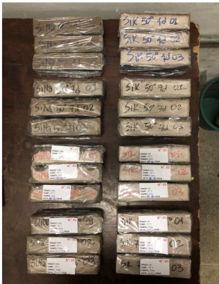
**Figura 30.** Armazenamento das barras enquanto aguardavam as próximas etapas de ensaios. Fonte: Autor (2018).
