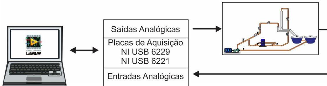
**Figura 5.7** Esquema ilustrativo da bancada de testes.
