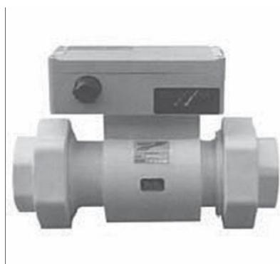
Figura 4.8 – Transdutor de Vazão
