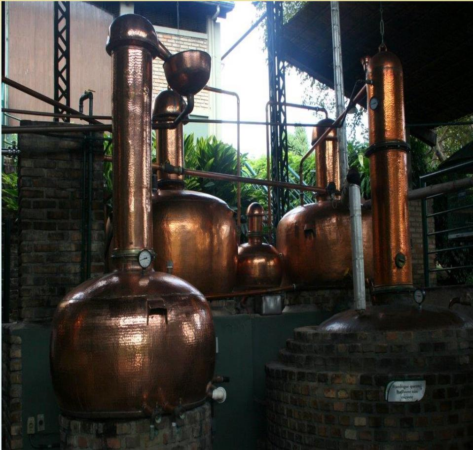
O cobre é o material mais utilizado nas construções de alambiques, pois tem a capacidade de catalisar reações químicas e contribuir na eliminação de odores desagradáveis.
