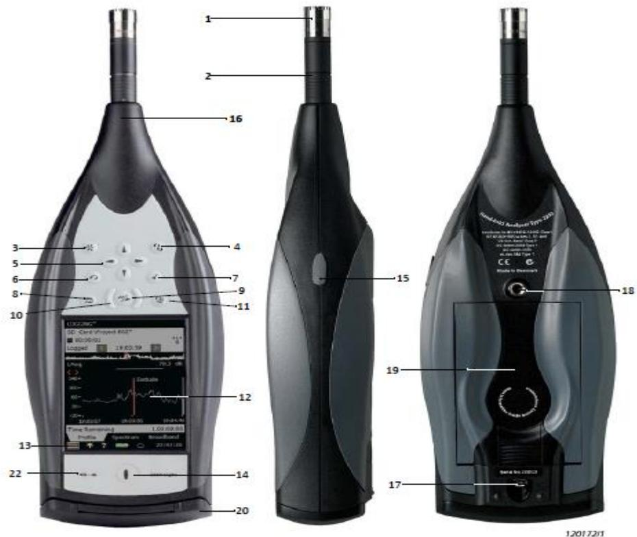
1. Microfone de medição: Um microfone robusto e confiável com uma ampla faixa de frequência.
