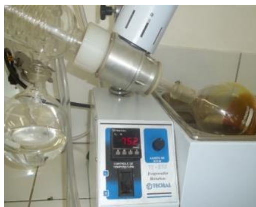
Figura 20 - Separação do solvente e do extrato de Gengibre ( Zingiber officinalis ) no Rotaevaporador.
