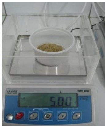
Figura 17 – Balança Semi-analítica utilizada na pesagem dos vegetais.
