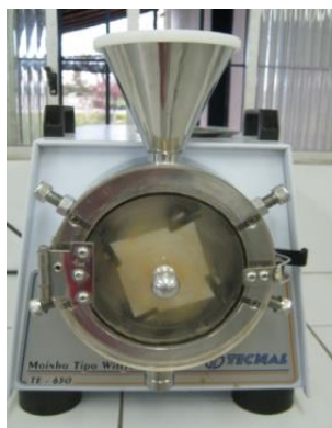
Figura 16 – Triturador (moinho de facas) utilizado na trituração de plantas secas.
