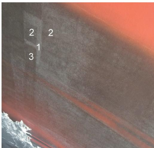
**Fig. 2** Área com mofo intacto (1); áreas limpadas com água sanitária em duas passagens – 1 parte para 8 (2); área limpada com vinagre em duas passagens – 1 parte para 5 (3).
